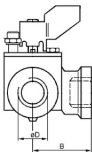
Nom : **Vannes À Secteur 3 Voies PN10 avec raccords taraudés - SIEMENS : VBI31.20**
