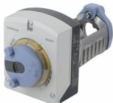
Nom : **Servomoteur 800N 20mm 3pts 120s 24Vac/Vcc -
