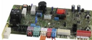
Nom : **Circuit imprimé - VAILLANT : 0020092478**
