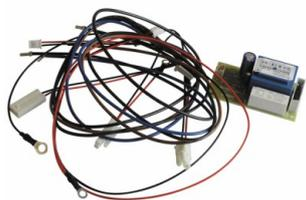
Nom : **Circuit imprimé anode électronique - CHAFFOTEAUX : 925348-01**
