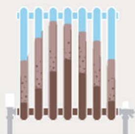
**5:** Expliquer également que la présence de métaux différents, ce qui arrive fréquemment dans les installations de chauffage, est un autre facteur d'accélération de la corrosion si les installations ne sont pas traitées. Expliquer les risques associés à la corrosion et les coûts élevés qu'elle peut induire.
