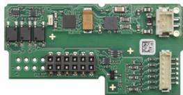
Nom : **Module de communication pour SENSOSTAR U-C - ENGELMANN SENSOR : 9100600030**
